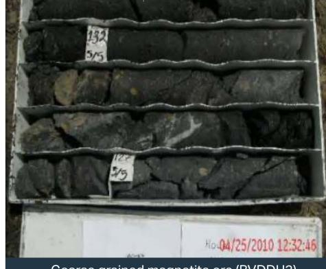
Coarse grained magnetite ore (BVDDH3)
