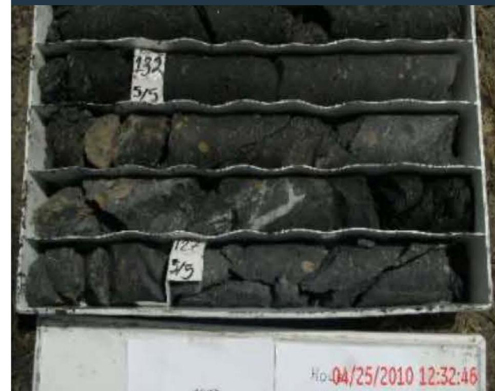
Coarse grained magnetite ore (BVDDH3)
